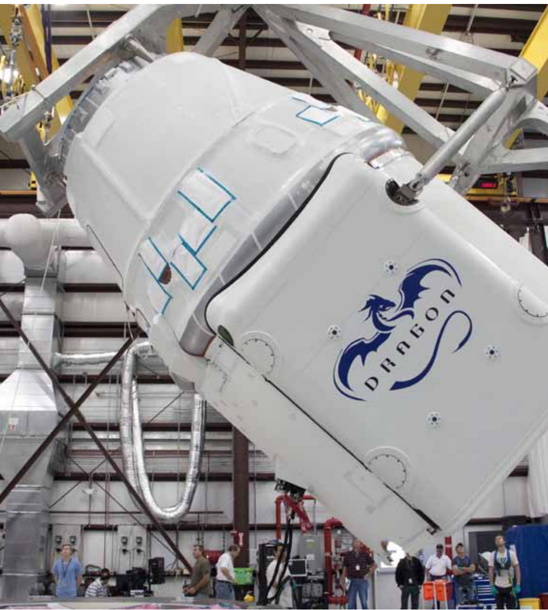
Капсула «Dragon» поворачивается в горизонтальное положение для стыковки с ракетой «Falcon 9»
